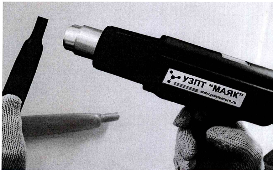
Рисунок 1 – Процесс термоусадки ТУТ
